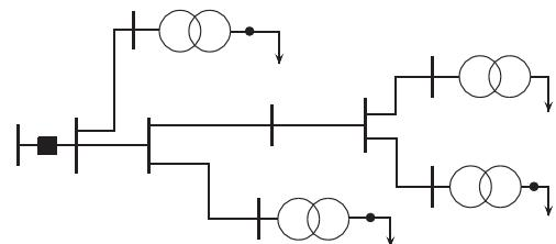
• 变压器量测终端, ■ 变电站馈线出口处量测装置
