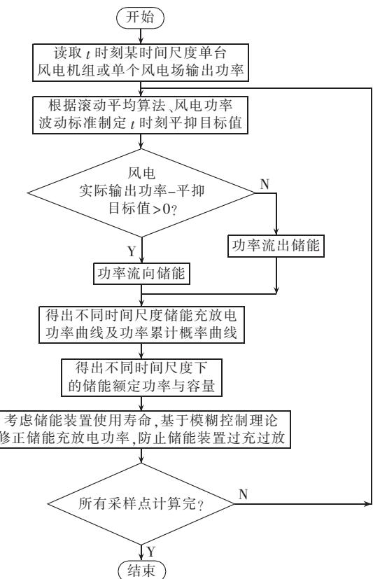
图14 储能平抑风电输出功率变化率流程图
