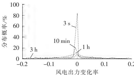
图3 多时间尺度下单一风电机组出力变化率情况
