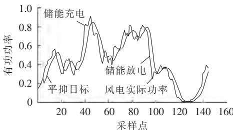
图6 储能充放电控制策略示意图
