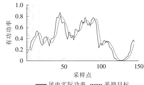
图5 风电实际功率与平抑目标
