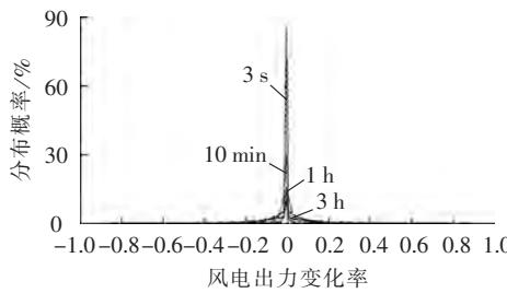
图4 多时间尺度下整个风电场出力变化率情况
