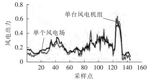
图2 单台风机、单个风电场输出功率对比
