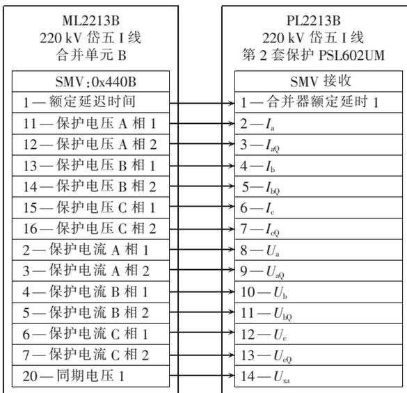
图 5 虚端子连接图
