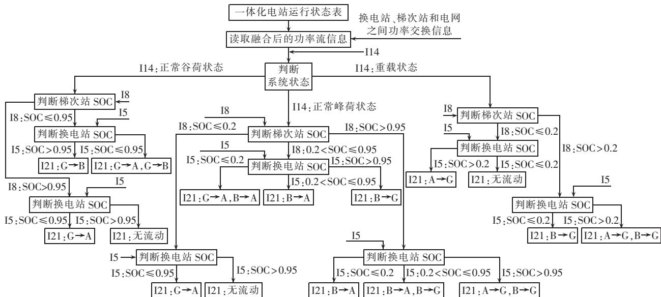
图 5 一体化电站运行状态信息融合流程
