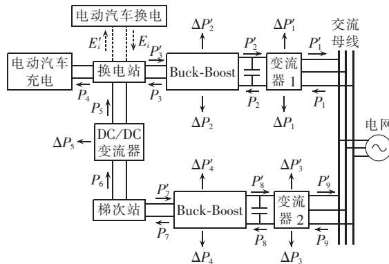
图4 一体化电站原理结构及功率流动
