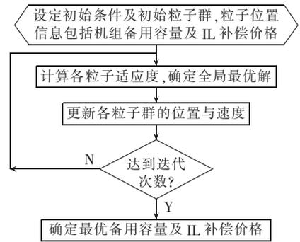
图 2 粒子群算法流程
