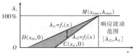
图 1 计及不确定性的可中断负荷用户响应特性曲线
