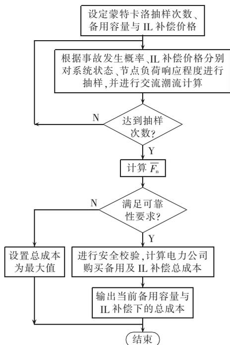
图 3 粒子群算法适应度函数计算流程
