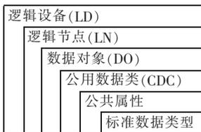
图 7 逻辑设备信息结构模型
