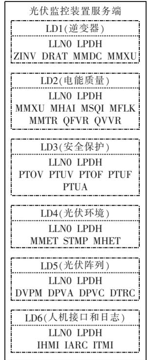
图 8 光伏监控装置信息模型
