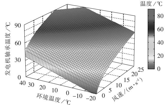
图 3 发电机轴承温度拟合曲面
