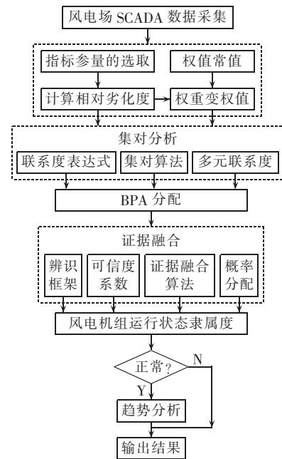
图 5 风电机组运行状态评估流程图
