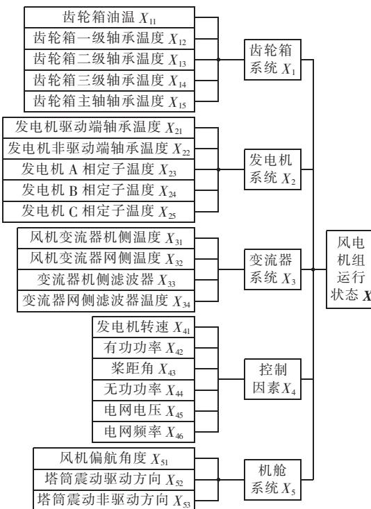
图 1 风电机组运行状态评估指标结构
