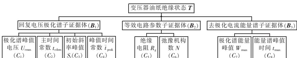
图 5 变压器油纸绝缘状态评估体系
