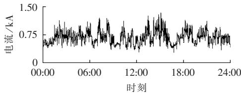
图 10 重载铁路某牵引变电所全天负荷过程图
