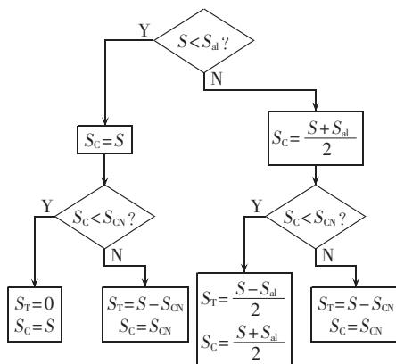
图 12 同相补偿装置的第 3 种运行方式
