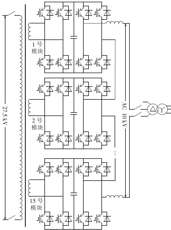
图 3 同相补偿变流器结构图
