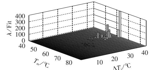
(b) 逆变侧 IGBT 的故障率分布图
