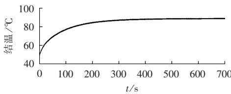
图 6 额定工况下逆变侧 IGBT 的结温变化
