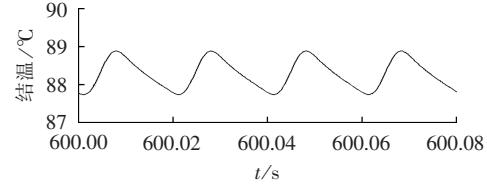
图 5 额定工况下逆变侧 IGBT 的瞬时结温
