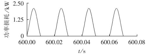
图 4 额定工况下逆变侧 IGBT 的瞬时功率损耗
