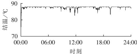
图 14 第 3 种运行方式下逆变侧 IGBT 的结温
