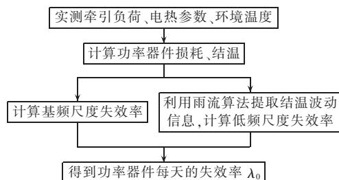
图 2 同相补偿变流器可靠性评估流程图
