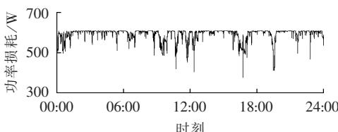
图 13 第 3 种运行方式下逆变侧 IGBT 的功率损耗
