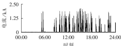
图 7 高速铁路某牵引变电所全天负荷过程图
