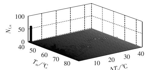
(a) 逆变侧 IGBT 的温度循环次数图
