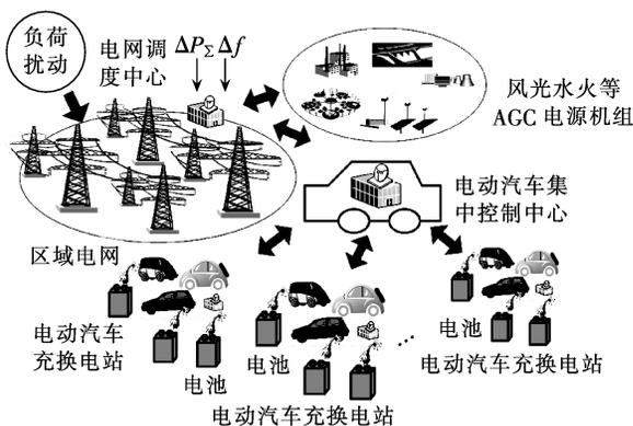
图 1 电动汽车充换电站参与 AGC 功率分配的框架
