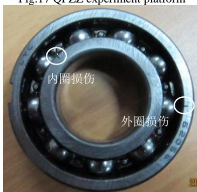
图 A2 滚动轴承外圈、内圈复合故障
