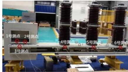
图 A1 试验断路器及传感器布置
