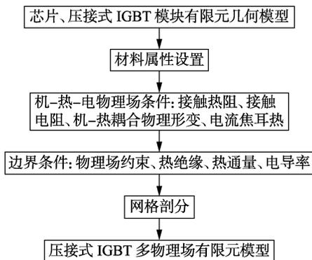
图 2 压接式 IGBT 器件多物理场建模流程图
