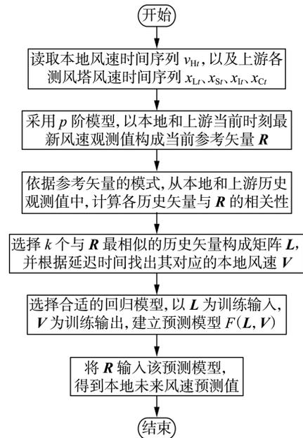
图 3 采用  $k$  近邻的空间相关性风速预测流程图
