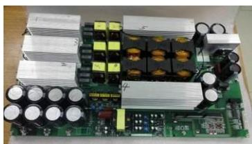
图 A2 LLC 谐振变换器实验样机
