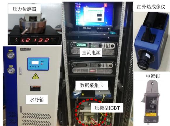
图 A11 压接型 IGBT 器件功率循环实验平台
