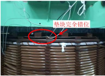
图 A2 压紧垫块完全错位示意图
