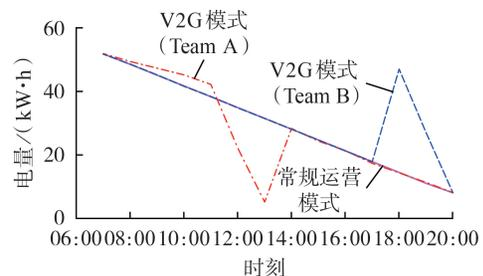
图 2 电动出租车的电量变化曲线
