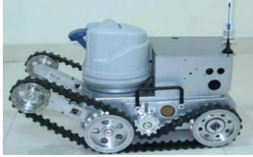
(b) 履带式陆地电缆机器人
