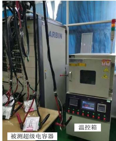
图 B1 超级电容测试系统实验平台
