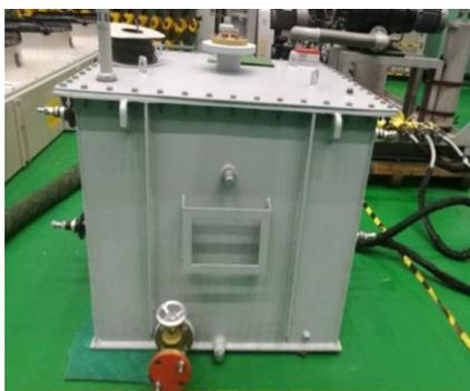
图 A1 双分裂电抗器实物图
