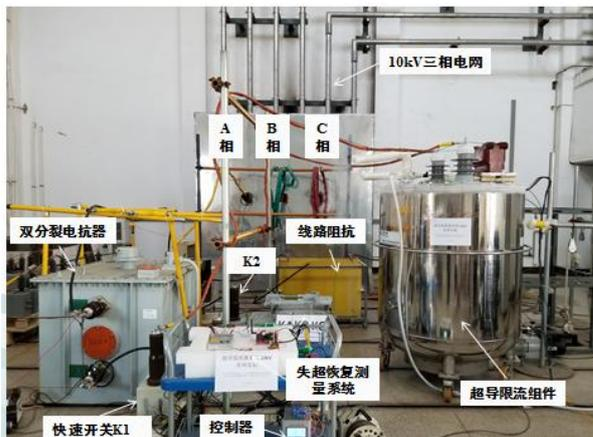
图 A6 磁偏置超导限流器试验布置图
