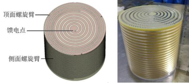
图 A3 阿基米德螺旋天线仿真模型及实物图
