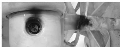
图 4 隔离开关气室绝缘拉杆闪络图
