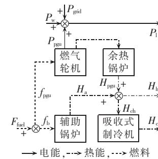
图1 冷热电联供系统能量流
