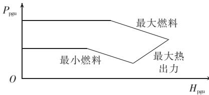
图 2 燃气轮机热电出力可行域
