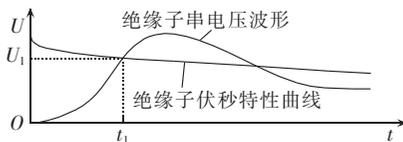
图 3 绝缘子闪络判断原理
