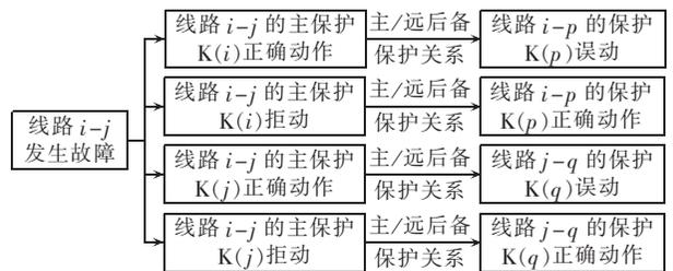
图 3 保护间不正确动作的关联模型
