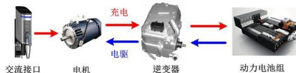
图 A1 EDRC 系统结构示意图
