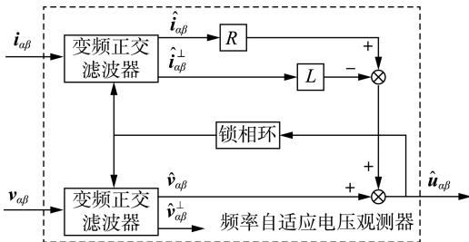
图 4 频率自适应电压观测器结构图
