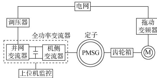
图12 直驱风力发电实验平台
