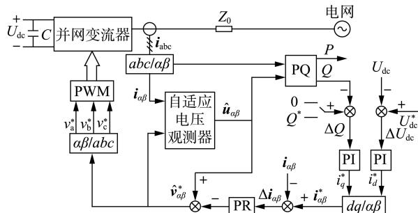
图8 具有参数自适应特性的无交流电压传感器控制框图
