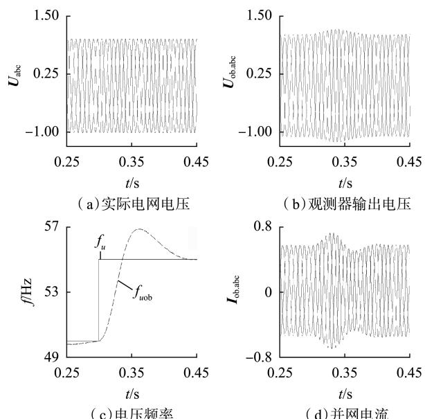
图9 使用频率自适应观测器的仿真结果
