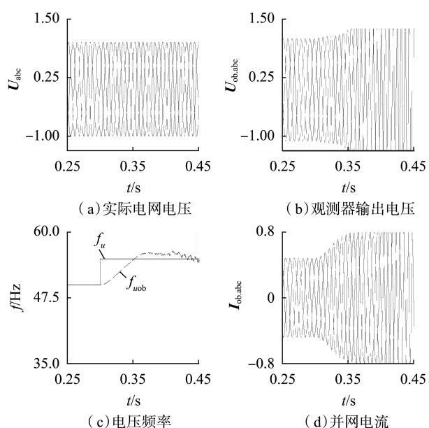
图10 使用固定频率观测器的仿真结果
