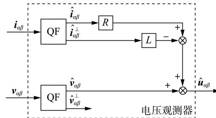
图 2 基本电压观测器结构图
