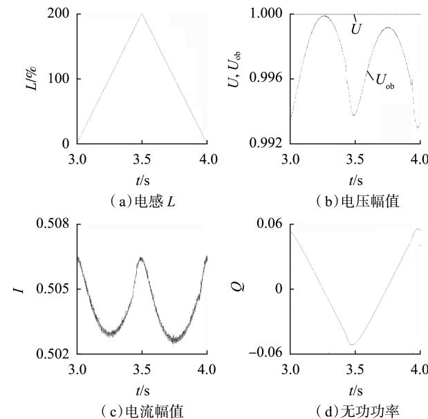
图11 使用电感参数自适应电压观测器的仿真结果
