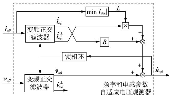
图7 具有参数自适应特性的电压观测器结构图
