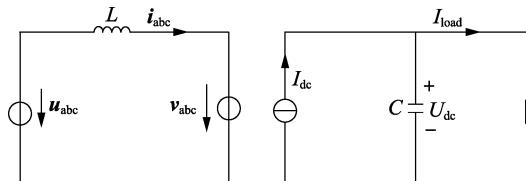
图 5 电压型变流器简化等效模型
