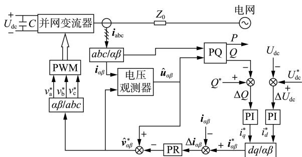
图 3 无交流电压传感器控制框图
