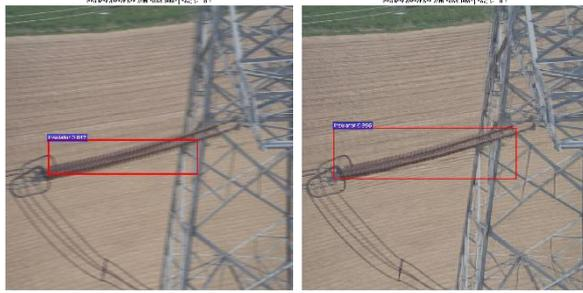
(a) 模糊的绝缘子图片检测结果 (b) BIID-WGAN 算法生成的清晰绝缘子图片检测结果
