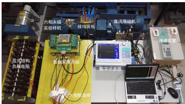
图 A3 六相永磁同步发电机样机实验平台
