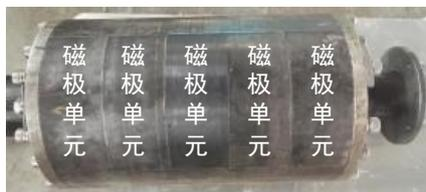
图 A4 实验样机转子结构示意图（正常转子的装配图）
