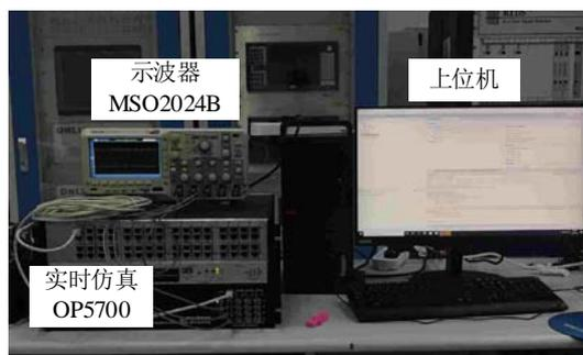
图 C1 基于 RT-LAB 实时仿真实验平台
