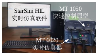
图 A9 StarSim HIL 硬件在环实验平台
