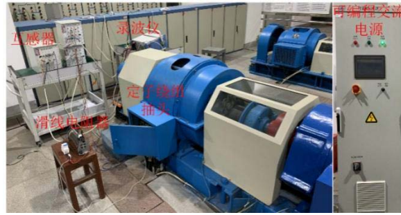
图 B1 动模试验系统实物图
