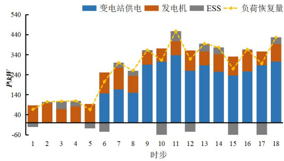
图 E2 MG 2 中的恢复情况 Fig.E2 Restoration condition of MG 2
